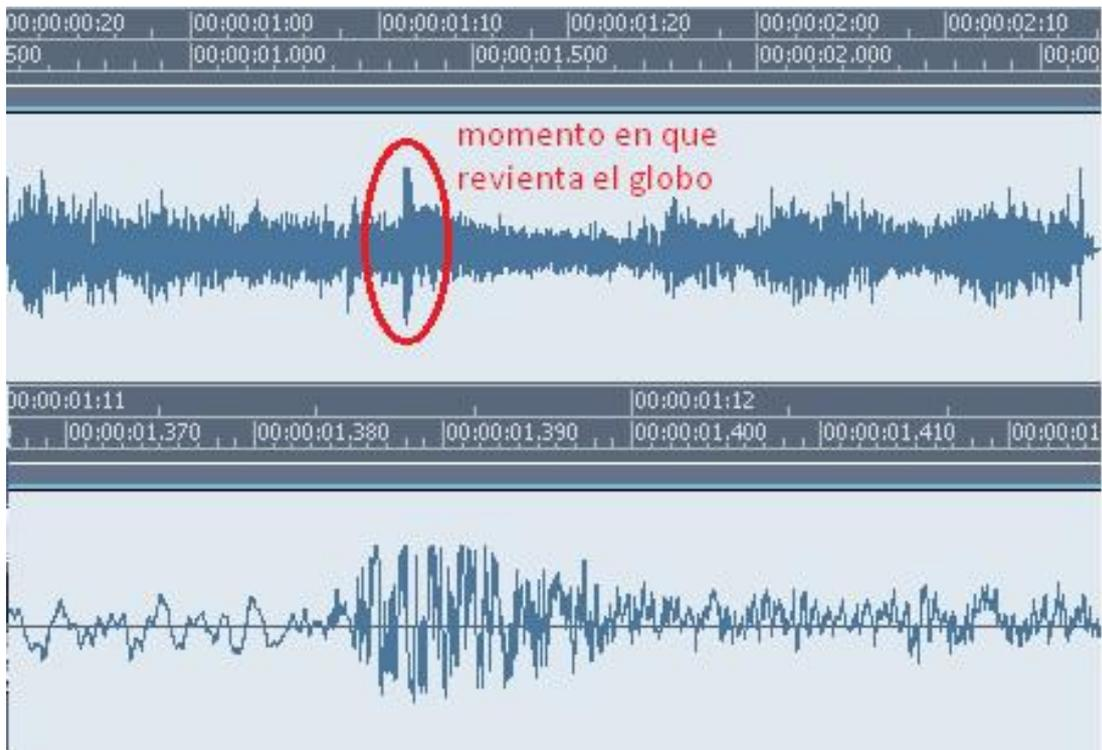
Figura 2: gráfico de la onda de sonido en la primer experiencia. En la figura superior se marca el pico que corresponde con el estallido del globo. En la figura inferior se ve la misma gráfica ampliada.
